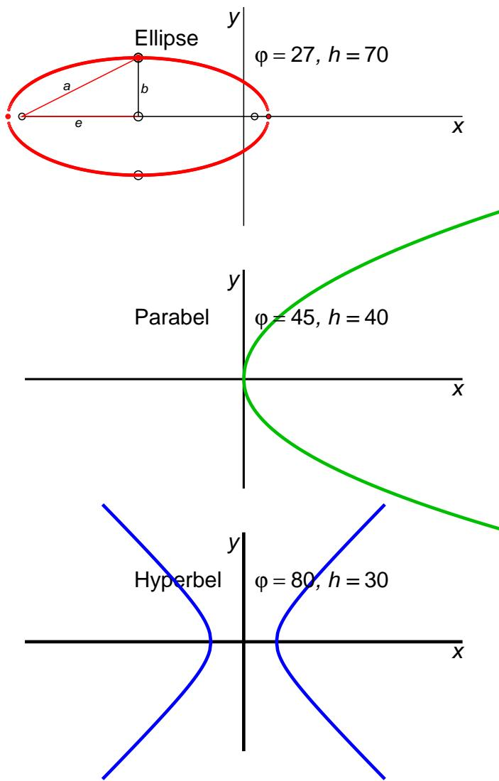
Abbildung 1: Ebene Schnitte durch einen Kegel (Gl. (1)):
